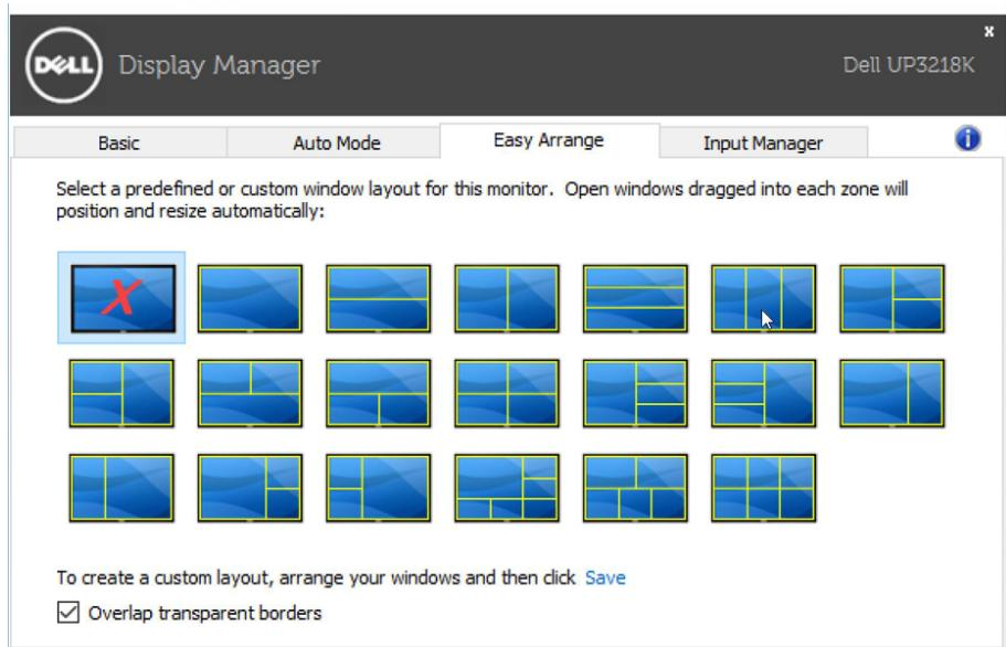
Чтобы создать окно с пользовательской компоновкой, задайте размер и положение окон (не более 10) на рабочем столе, а затем нажмите «Сохранить ссылку» в Easy Arrange. Сочетание размеров и положения окон будет сохранено как пользовательский макет, и будет создан значок пользовательского макета.
